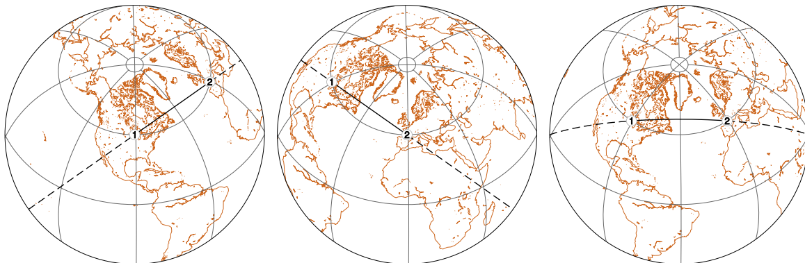
FIGURE I.3 – Grand cercle passant par deux points situés à la latitude 45^\circ et dont la différence de longitudes est de 90^\circ . Les trois cartes utilisent la même projection mais sont centrées différemment.
