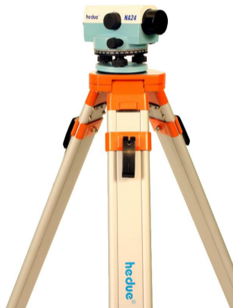
Visée optique + trépied
