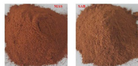
Latérites sénégalaises testées pour leur capacité de sorption de l'arsenic pour le traitement d'eaux contaminées (MAS: Massavey; SAB: Sabodala)
